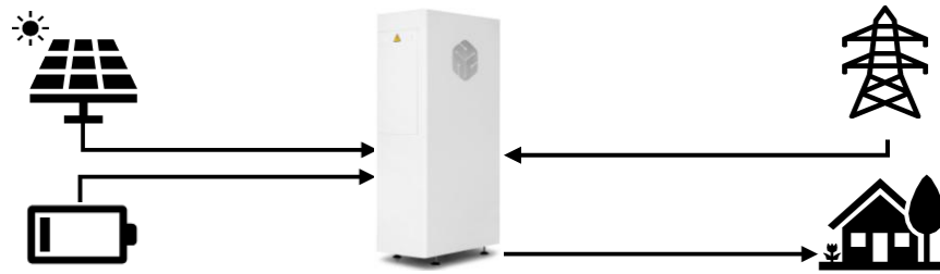
Ilustración 7. Diagrama del equipo en modo autoconsumo con importación de electricidad desde la red
