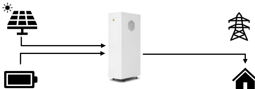
Ilustración 6. Diagrama del equipo en modo autoconsumo con las baterías cargadas.
