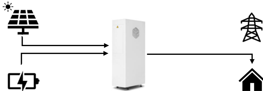
Ilustración 5. Diagrama del equipo en modo autoconsumo con carga de baterías
