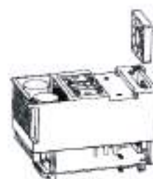
Paso 4: Sacar el ventilador
