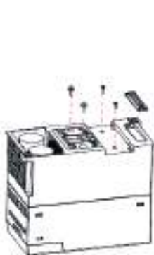
Paso 1: Retire los tornillos y el deflector del ventilador.
