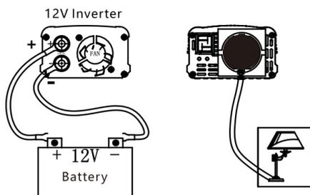
Por ejemplo, cuando la potencia de una carga CA de 100W, la corriente suministrada por la fuente de alimentación debe ser de  $100/10=10A$ . En caso de corrientes más elevadas, se pueden usar varias baterías en paralelo. Lo más importante es garantizar que la sección del cable sea suficiente. Este manual no recoge todos los tipos de batería. La carga y configuración de las baterías pertenecen a otra categoría profesional.
